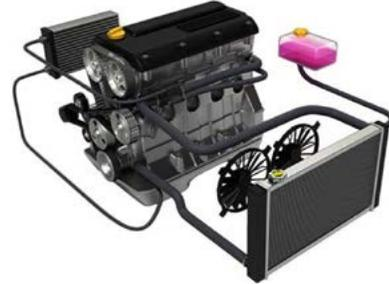
Evite dañar la bomba de agua. No debe ser golpeado el eje, ya que puede dañarse al igual que los rodamientos. Al instalar una bomba de agua nueva, siempre debe realizar una inspección al ventilador, tensores, poleas, bandas y al clutch del ventilador (si aplica).
