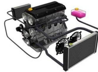
Veiller à ne pas endommager la pompe à eau avant son montage. Ne pas frapper sur l'arbre, car cela pourrait l'endommager, tout comme le roulement. Lors du remplacement de la pompe à eau, il faut toujours inspecter le reste du système de refroidissement : ventilateur, tendeur, poulie de renvoi, courroie et embrayage de ventilateur (le cas échéant).
